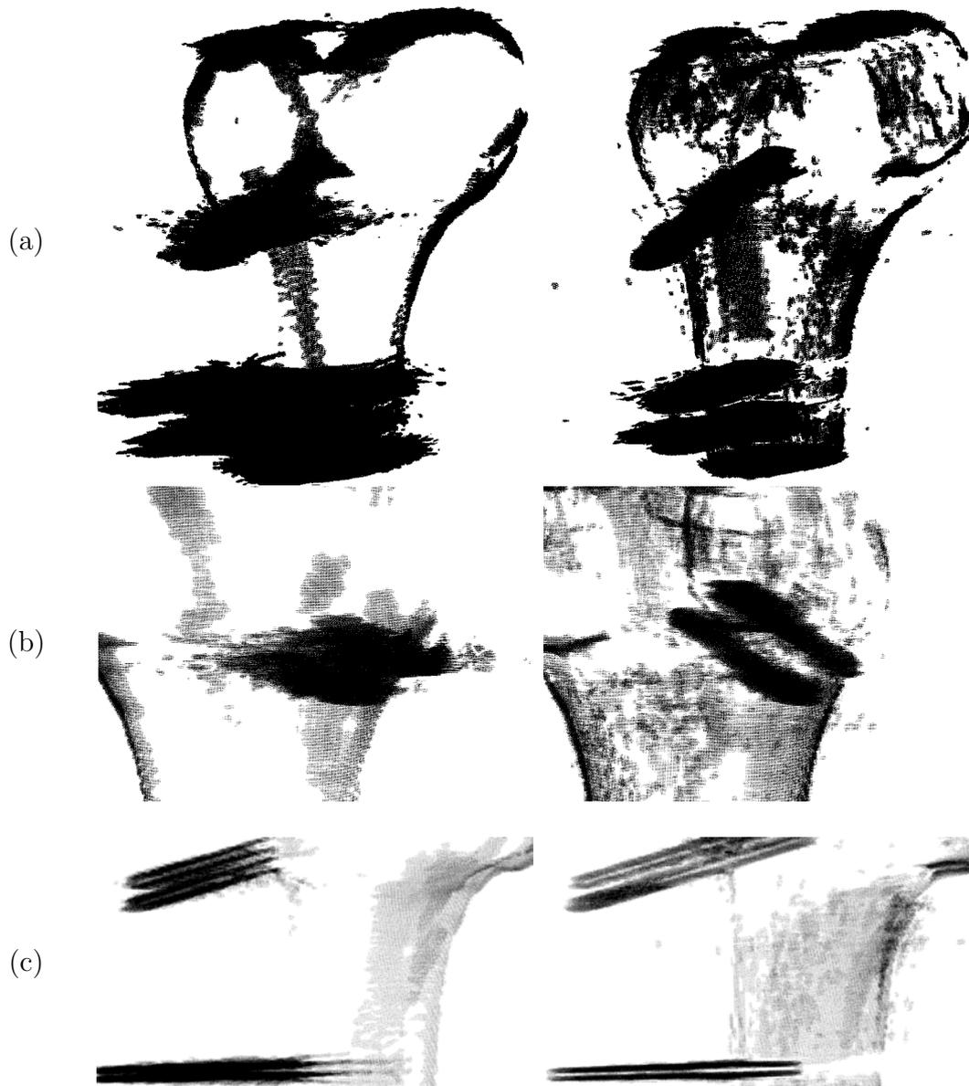
FIGURE 3.11 – (a) Comparaison des nuages de points obtenus par l'approche *volume complet* (gauche) et *par tranche* (droite). (b) Zoom sur les inserts métalliques supérieurs : la nouvelle méthode permet d'obtenir une meilleure définition de ceux-ci (c) Zoom sur la paroi osseuse entre les deux paires d'inserts : la première approche ne permet pas de distinguer l'interface alors que l'approche par tranche permet de placer des points délimitant le bord osseux.
