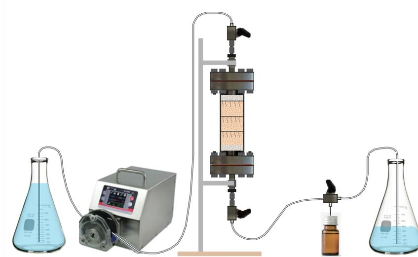
**Figure 3.4:** Montage expérimental lors des phases d'injection d'eau froide en cellule
