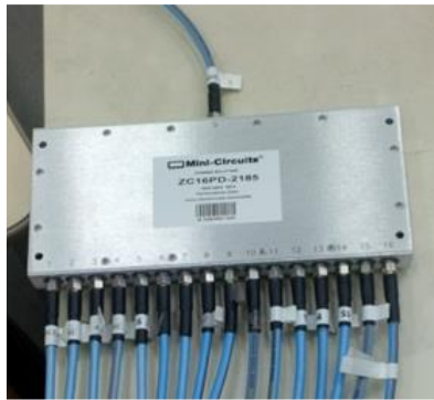
Figure 107 : Diviseur de puissance 1 voie vers 16 ( Mini-Circuits , ZC16PD-2185).
