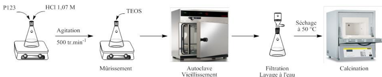
Figure 4.7 : Schéma de synthèse de la silice mésoporeuse SBA-15
