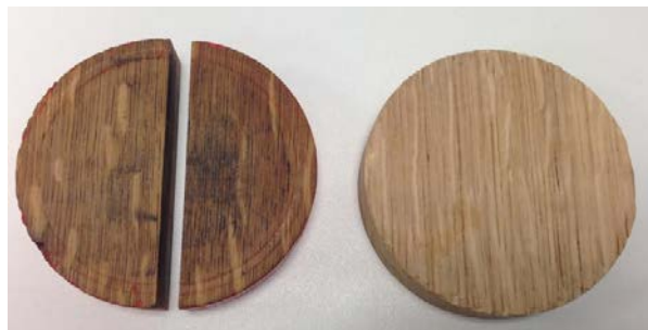
Photo 12 : Eprouvettes utilisées : coupée en demi-rondelles ou entière.
