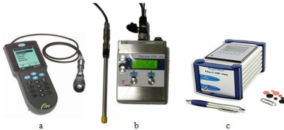
Figure 35 : (a). Sonde HQ10, (b). Sonde Oxylevel 2200, (c). Sonde Presens® et capteurs d'oxygène sous forme de pastille.
