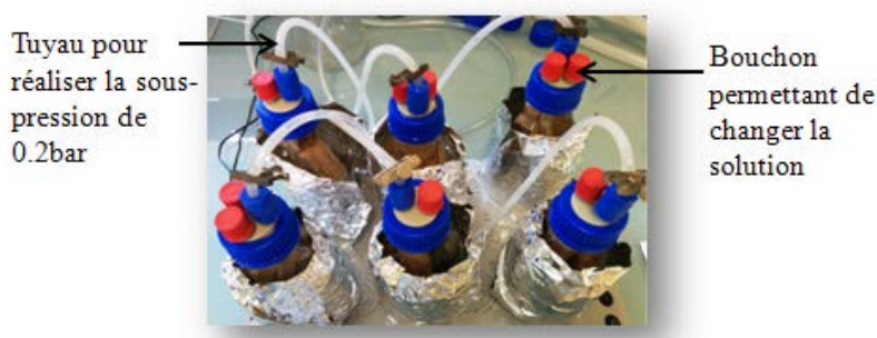
Figure 41 : Système de suivi de la désorption de l'oxygène du chêne sous vide.
