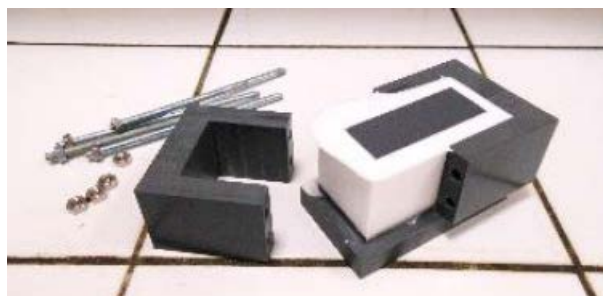
Photo 9 : Porte échantillon : joint en silicone et son moule.
