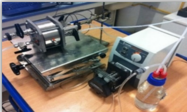
Figure 46 : Montage du perméamètre pour la série b.
