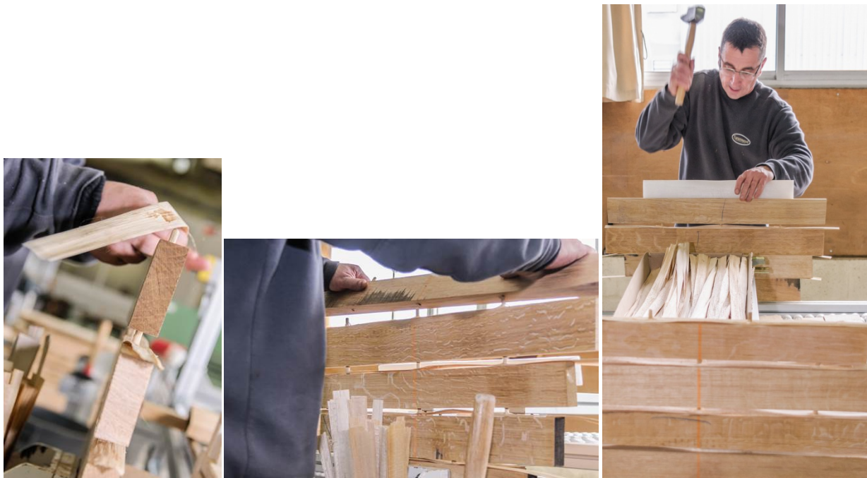
Figure 4 : Pièces constitutives des fonds de la barrique (Photographies Taransaud).
