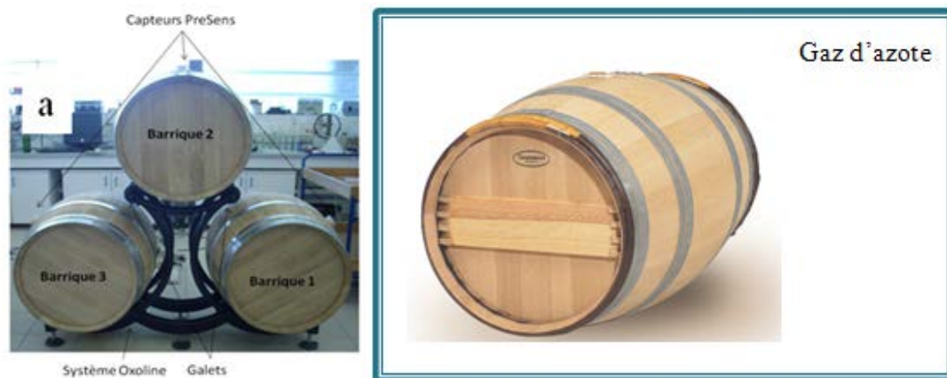
Figure 39 : Barriques d'essai. (a) barriques mises en condition ambiante, (b) barrique dans un caisson inerté à l'azote (Barriques fournies par Chêne et Cie.).
