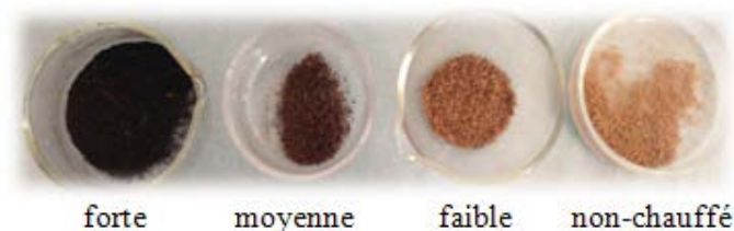
Photo 8 : Surface chauffée du bois réduite en poudre pour l'analyse B.E.T.
