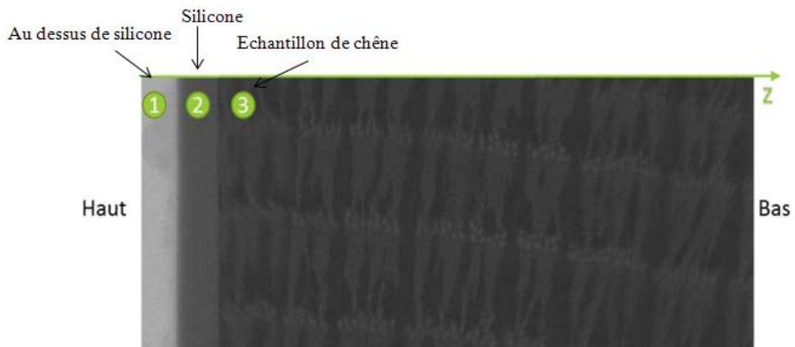
Photo 20 : Partie de l'image d'atténuation de l'échantillon sec.
