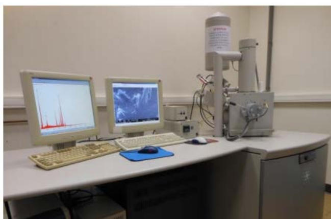
Photo 6 : Le microscope électronique environnemental ESEL FEI Quanta 200.
