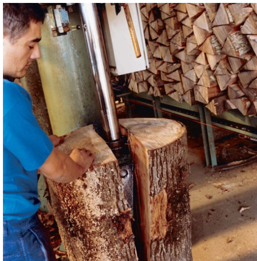
Photo 1 : Fendage d'un billon de bois (Photographie Taransaud).
