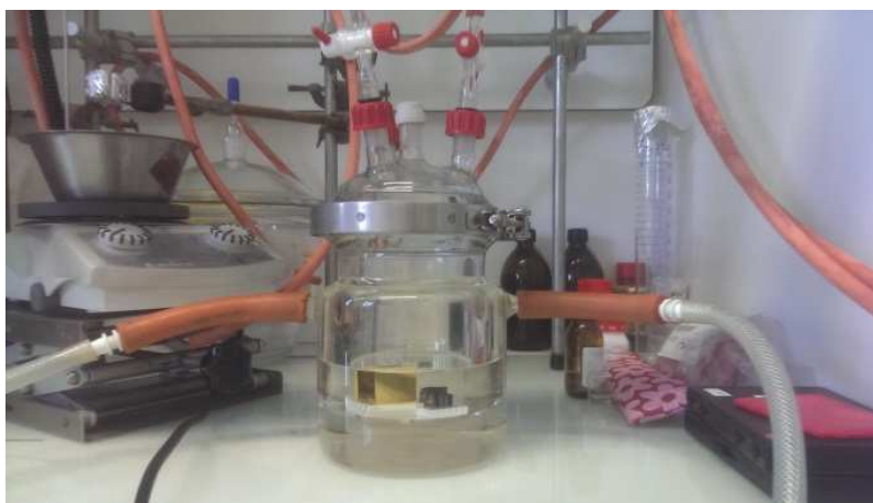
Figure 1 : photo du réacteur double paroi utilisé pour les greffages des SAMs
