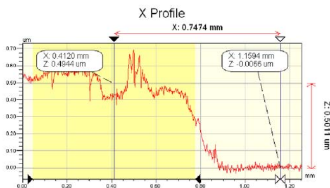
Figure IV. 19 Caractérisation par profilométrie optique a) profil 2 D du bord de la couche mince de MIP/AMP sur le capteur (380 nm, vitesse 2100 rpm), b) image 3 D de surface.
