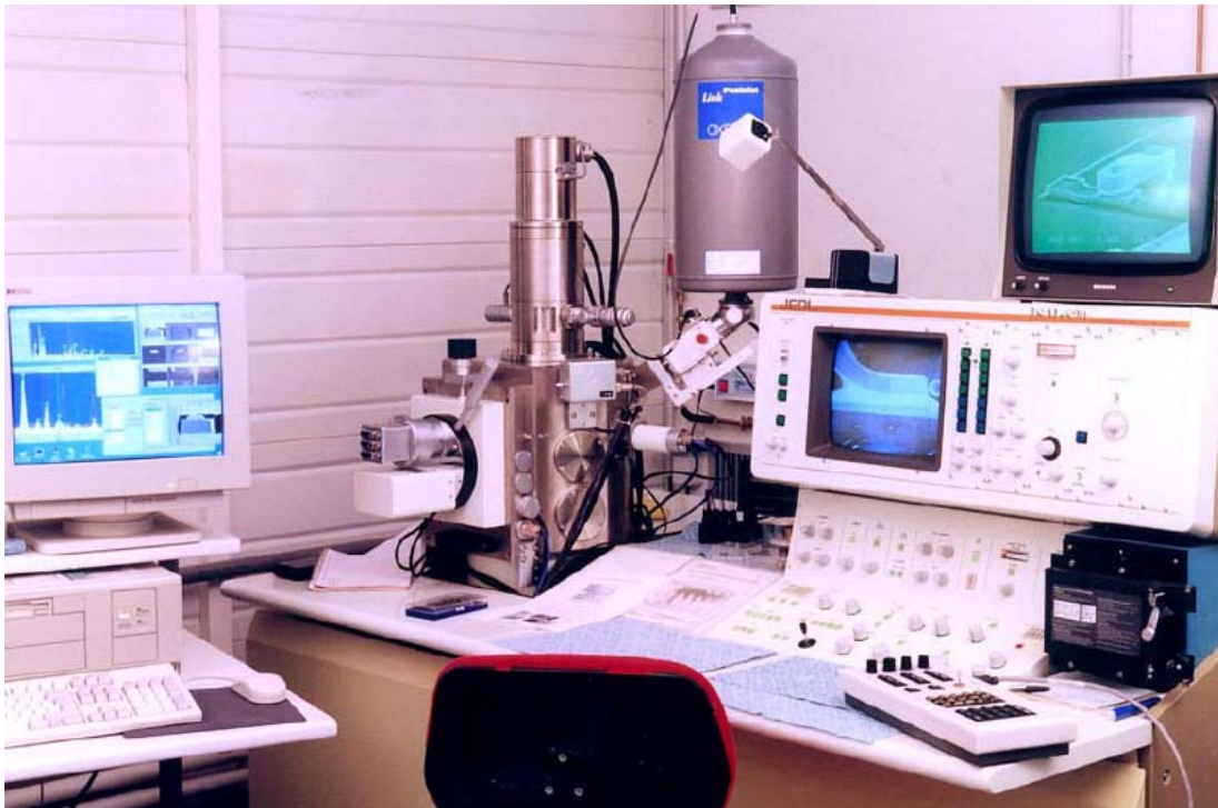
Exemple d'un MEB équipé d'un système d'analyse X par dispersion d'énergie et d'un processeur d'image (Laboratoire IMS).
