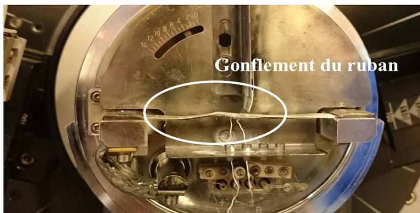
Figure A1-4. Exemple de gonflement du ruban de platine
