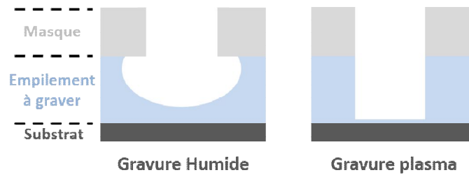
Figure I-4 : Caractéristique d'une gravure humide et d'une gravure plasma
