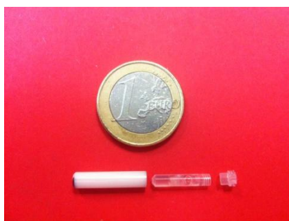
Figure 19 : Photographie du dispositif HR-MAS utilisé pour la préparation des différents échantillons étudiés à l'aide de cette technique. De gauche à droite sur la Figure : le rotor, l'insert jetable de 33 \mu l et le capuchon (ailettes).
