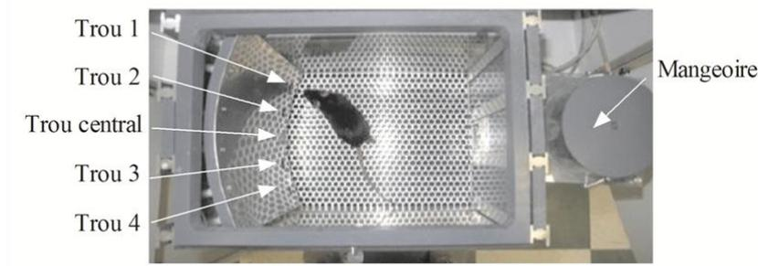
**Figure 35 :** Photographie d'une cage de conditionnement opérant. Il existe 5 trous (1, 2, 3 et 4 ainsi que le trou central utilisé pendant l'habituation). Ces trous peuvent être accessibles ou non selon les besoins expérimentaux. La mangeoire se trouve sur la paroi opposée aux trous.
