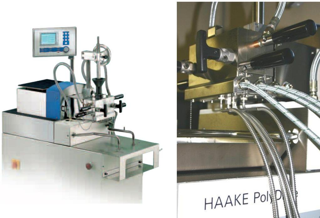
Figure 6.1 : photos d'un malaxeur Polydrive Haake. L'image de droite, tirée du site internet du CRIIT Matériaux Alsace, est un zoom de la chambre de malaxage.
