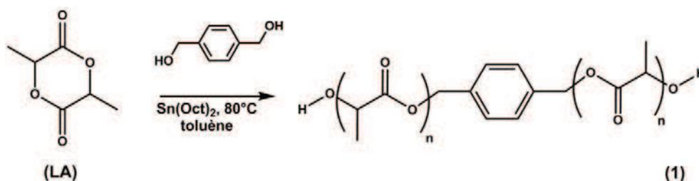
Schéma V-11 Synthèse du poly(acide lactique)  $\alpha,\omega$  hydroxylé PLA(OH)<sub>2</sub>
