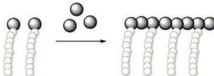
Figure I-6 Technique de « grafting through »
