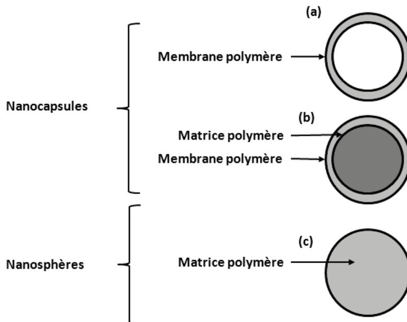
Figure I-18 Composition des nanosphères et nanocapsules<sup>185</sup>
