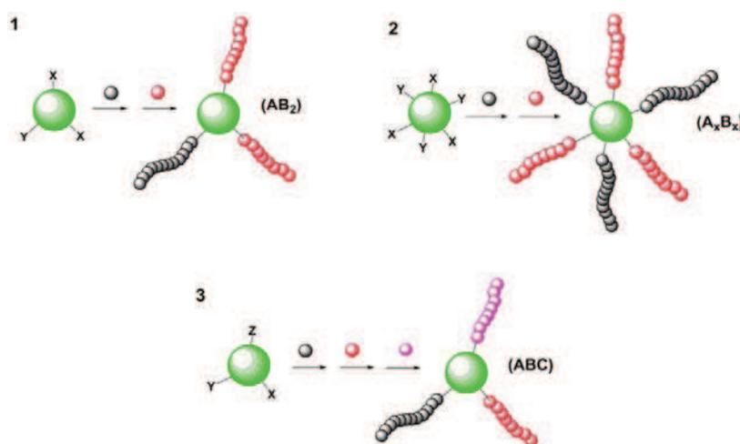
Figure I-12 Architectures « miktoarm » par la méthode « core first »
