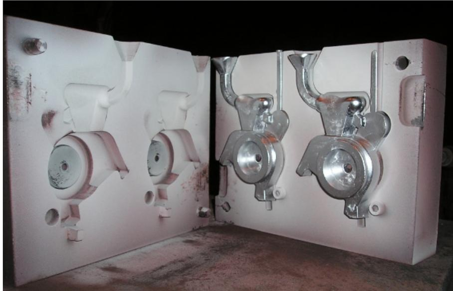
FIGURE 1.3 – Exemple de moule et de pièce du procédé de moulage par gravité (Source : fonderie-mrt.fr)
