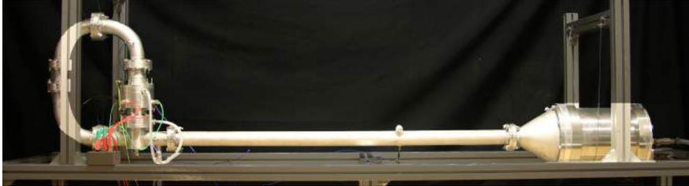
**FIGURE B.1** – Photographie du prototype de transducteur thermo-acousto-électrique du Laboratoire d’Acoustique de l’Université du Maine, montrant à gauche moteur thermoacoustique annulaire, et à droite le volume couplé à l’alternateur.
