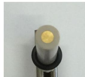
*Electrode millimétrique d'or ( $S=0,07\text{cm}^2$ )*
