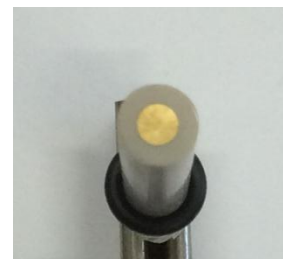
Electrode millimétrique d'or ( S=0,07\text{cm}^2 )
