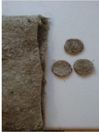
Figure 51 : Biosorb découpé sous forme de disques pour réaliser les expériences en colonne.
