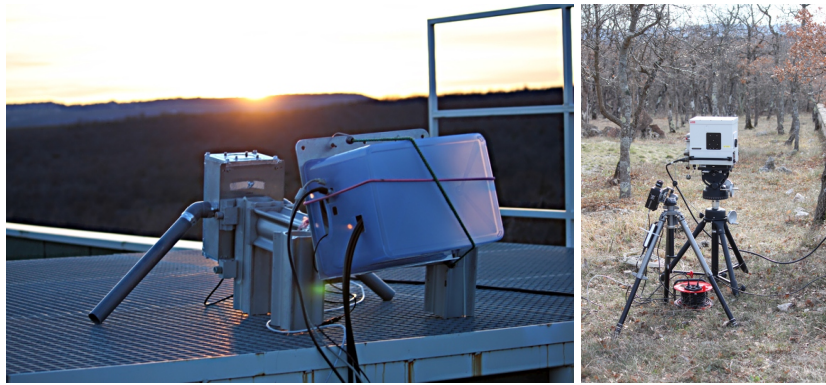
FIGURE 4.7 – Instruments déployés lors de la campagne à l’OHP. À gauche, la caméra InGaAs automatisée, le spectromètre ANDOR. Sur la photo de droite, une seconde caméra InGaAs et le spectromètre.
