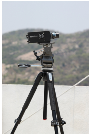
FIGURE 4.1 – Caméra InGaAs montée sur trépied durant la campagne à Gadanki.
