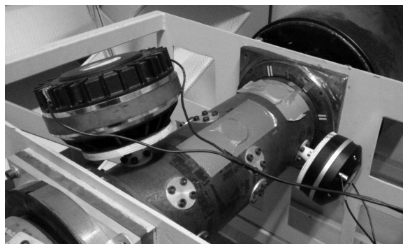
Fig. 4.3 Photo du tronçon source du banc acoustique.
