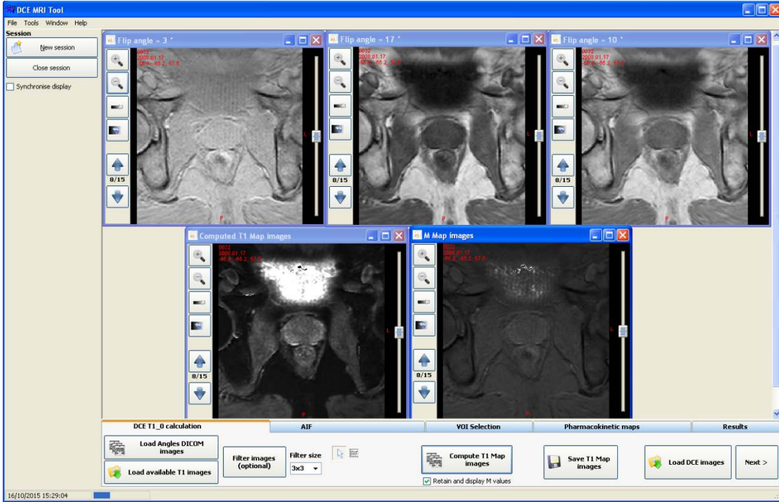
Figure 17 : capture d'écran du logiciel DCE_MRI Tool, lors de l'étape de calcul de la cartographie T1(0), avec les trois images du haut correspondant aux séquences en écho de gradient T1 avec un angle de bascule différent (de gauche à droite : 3 – 10 et 17°). En bas, à gauche on retrouve la cartographie T1(0) et à droite la cartographie de la constante m, calculée par la méthode de régression linéaire.
