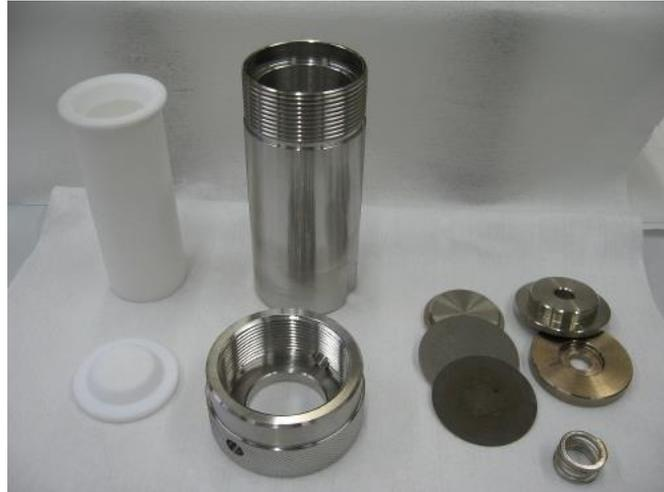
**Figure 3. Autoclave de 50 ml**
