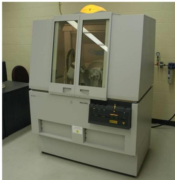
**Figure 5. Diffractomètre X'pert Pro de PHILIPS**
