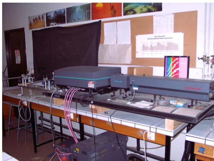
**Figure 1.** Laser à colorant pompé par un laser YAG :  $Nd^{3+}$  à impulsions.
