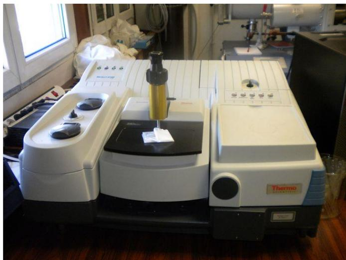
**Figure 16. Spectromètre à transformée de Fourier NICOLET 5700**
