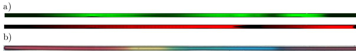
FIGURE 5.34 – Matériaux réalisés à l'aide du dispositif à 3 vannes. a) Images de fluorescence d'un même matériau observé à des longueurs d'onde différentes : 3 sinusoïdes en vert et 2 gradients linéaires en rouge. b) Matériau *arc-en-ciel* réalisé à partir de solutions colorées.
