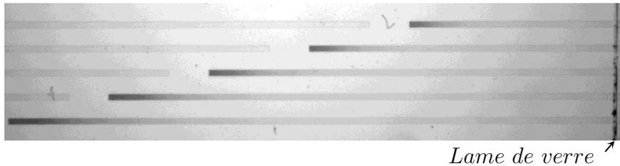
FIGURE 3.3 – Cliché en vue de dessus réalisé à l'aide d'un stéréomicroscope d'une évaporation d'un mélange PVA/NTC à un instant  $t$ . Le trait noir situé à gauche est un bord de la lame de verre sur laquelle repose le dispositif contenant des canaux de  $150 \mu\text{m}$  de large et de longueurs comprises entre 5 et 15 mm.
