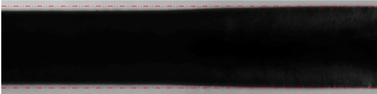
FIGURE 3.8 – Cliché d'une évaporation centrée sur la position du front de croissance. Les lignes rouges sont parallèles,  $w = 150 \mu\text{m}$ .
