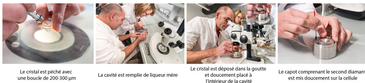
Figure 3.7. Les différentes étapes de chargement du cristal dans la CED. ©CEA/D. Morel
