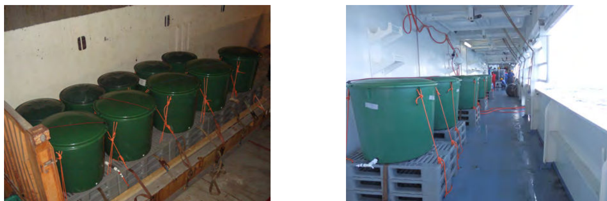
FIGURE 3.2 – A gauche : cale du R/V Marion Dufresne hébergeant les cuves de stockage des échantillons d'eau de mer prélevés en surface pendant la campagne KEOPS-2. A droite : coursive du R/V Pourquoi Pas ? hébergeant les cuves de stockage des échantillons d'eau de mer prélevés en surface pendant la mission GEOVIDE (Annexe A).
