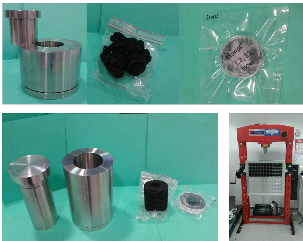
FIGURE 3.15 – Outils permettant d'adapter la géométrie de la fibre Mn (en haut) ou de la cartouche Mn (en bas) à la mesure sur le détecteur semi-planaire. Presse hydraulique permettant la transformation des échantillons.
