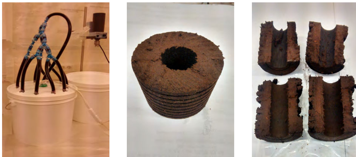
FIGURE 3.5 – Système d'imprégnation "à cœur" des cartouches par le \text{MnO}_2 et photos des cartouches imprégnées de \text{MnO}_2 .
