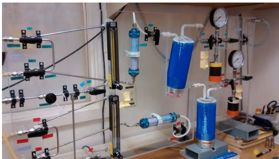
FIGURE 3.19 – Système de transfert du Rn des échantillons sous forme de fibre Mn vers les cellules Lucas. Système adapté de Key et al. (1979). Laboratoire Woods Hole Oceanographic Institution, USA.
