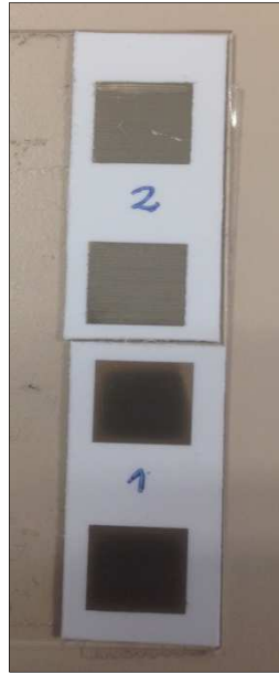
Figure III-10.- Echantillons d'un motif carré imprimé sur papier avec 1 et 2 couches d'encre métallique déposées.
