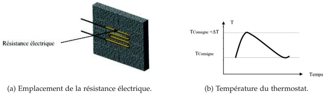
FIGURE 2.11: Source de chaleur sur la face amont de l'échantillon.
