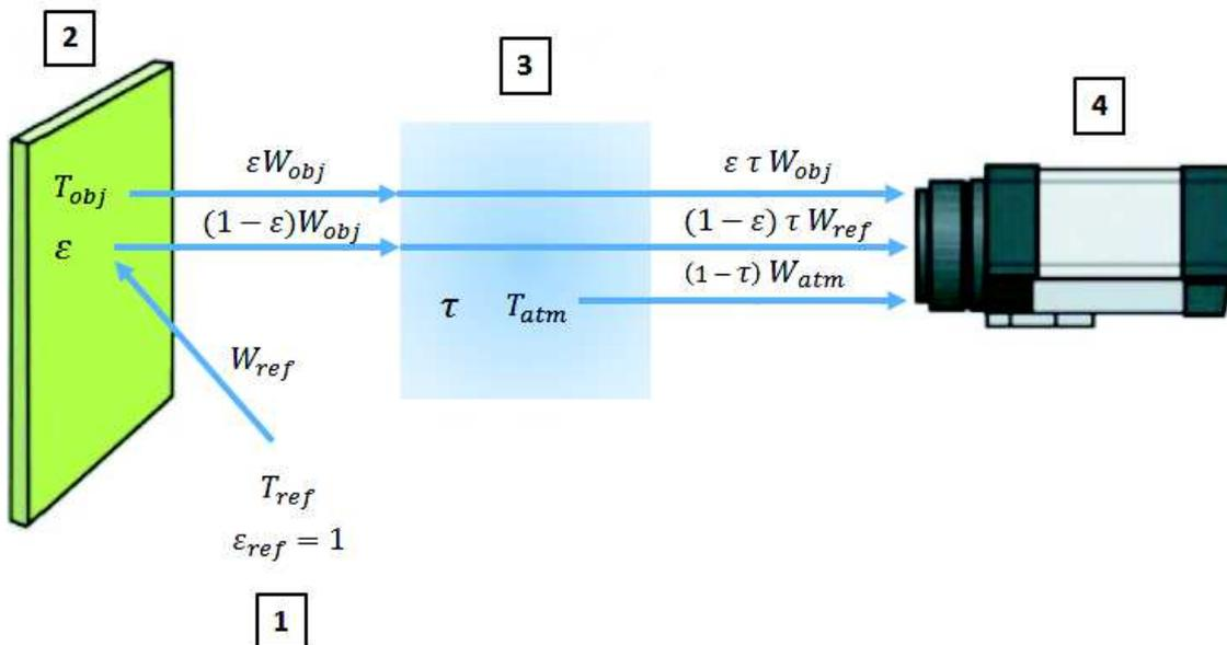
FIGURE 2.16: Thermographie infrarouge : Processus du transfert de chaleur [71].
