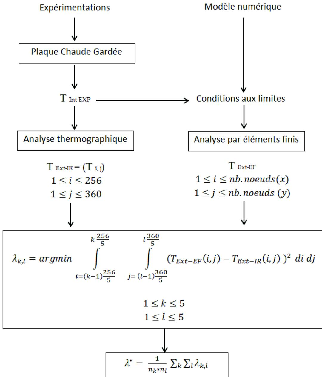
FIGURE 3.5: Procédure de détermination de la conductivité effective.
