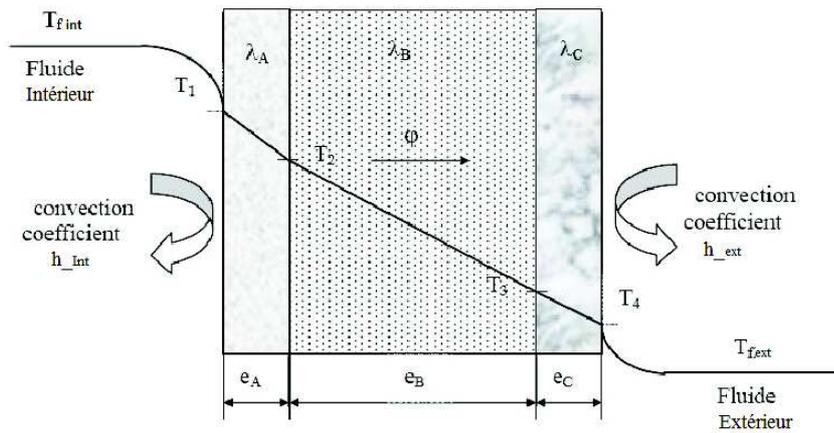
FIGURE 1.8: Mur multicouches placé entre deux fluides.
