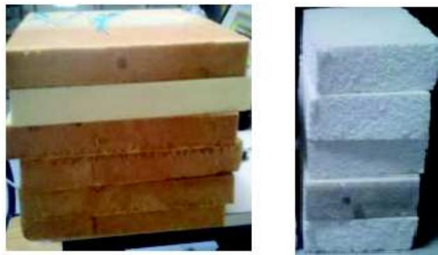
FIGURE 2.9: Isolants à structure visuellement homogène.
