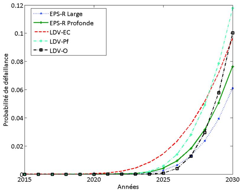
FIGURE 3.21: Evolution de la probabilité de défaillance de l'isolation en fonction du type de défaut.
