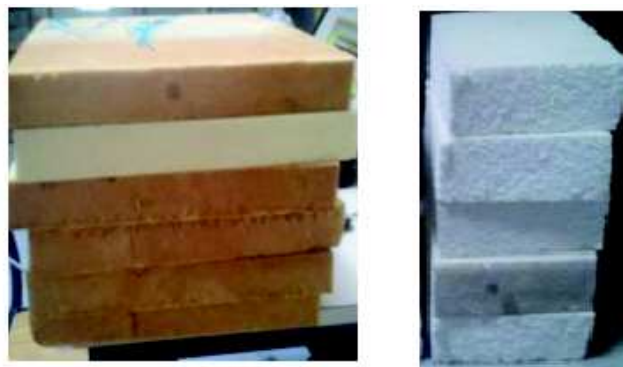
FIGURE 2.9: Isolants à structure visuellement homogène.
