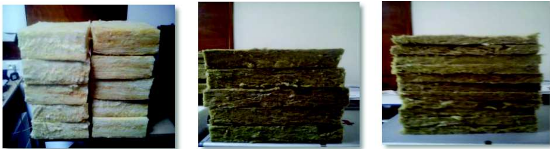
FIGURE 2.8: Isolants à structure visuellement hétérogène.
