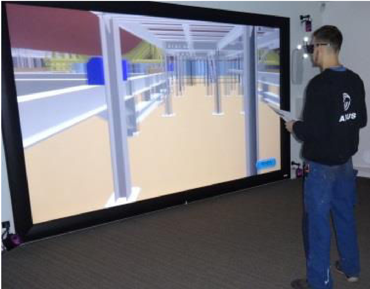
Figure 2 : Mur immersif du Technocampus Smartfactory de Montoir de Bretagne. On peut voir un opérateur de chez Airbus équipé des lunettes stéréoscopiques sur lesquelles sont disposés des marqueurs (boules réfléchissantes) dont la localisation est capturée via les caméras dont trois sont visibles sur la photo (aux coins du mur). Un système à double rétroprojection assure l’affichage des deux images sur l’écran.
