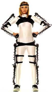
Figure 2.9 - Système de capture mécanique Gypsy (source : [www.metamotion.com](http://www.metamotion.com)).
