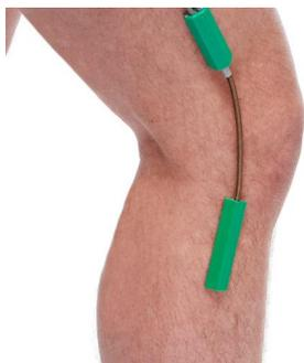
Figure 2.8 - Goniomètre placé sur le genou (source : [www.biometricsltd.com](http://www.biometricsltd.com)).
