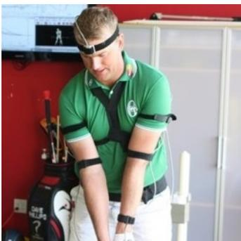
Figure 2.10 - Mesure d'un geste de golf avec un système électromagnétique (source : [www.bestperformancegroup.com](http://www.bestperformancegroup.com)).
