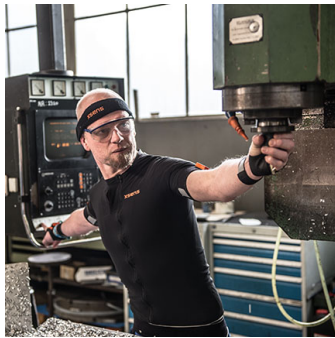
Figure 2.11 - Mesure d'une tâche de travail à l'aide de centrales inertiels (source : www.xsens.com ).
