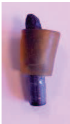
Photo 3.1 : Photo d'électrode de carbone vitreux propre.
