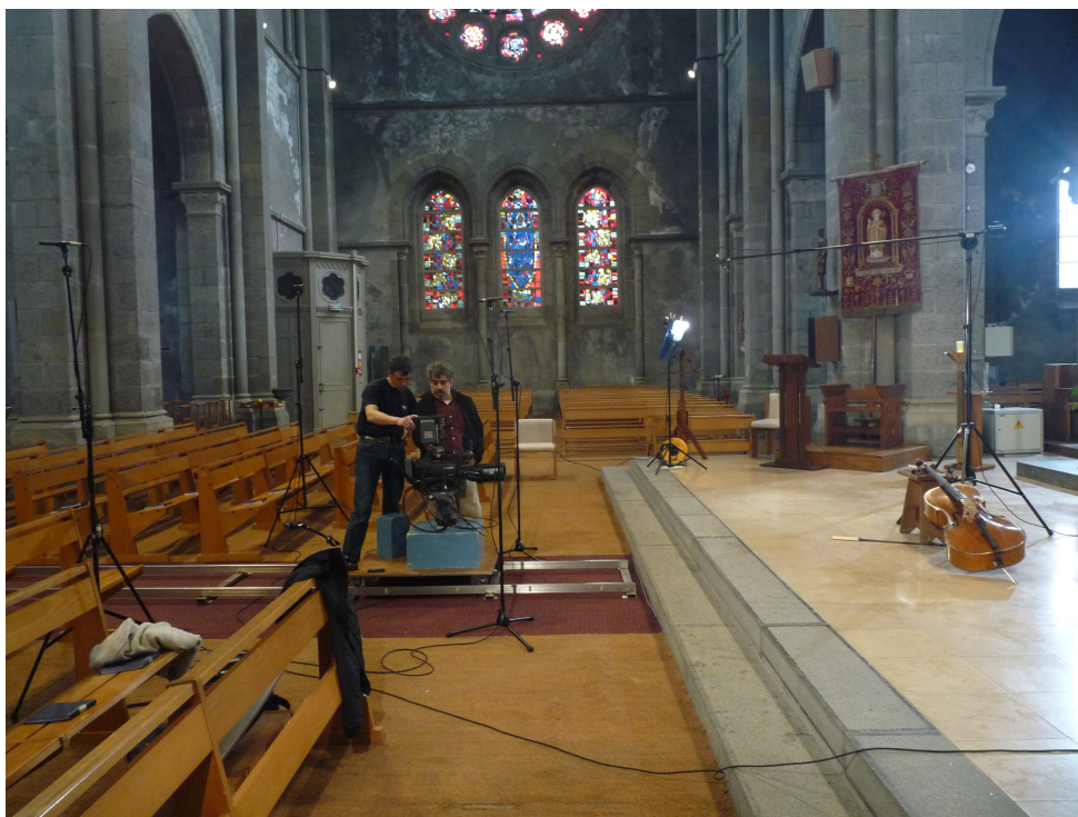
FIGURE 4.1 – Photo du tournage des séquences 1 et 2 de l’expérience I, avec la caméra 3D-s, le rail de travelling ainsi que le système Fukada Tree (5 microphones cardioïdes).
