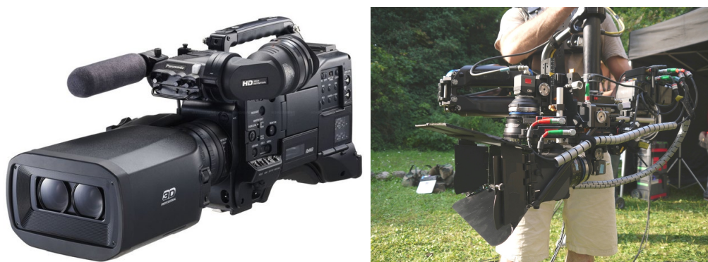
FIGURE 2.6 – Les deux caméras utilisées dans le cadre de la présente étude. A gauche : Caméra Panasonic AG-3DP1 avec lentilles côte à côte. A droite : Sinacam 3D avec miroir semi-réfléchissant.
