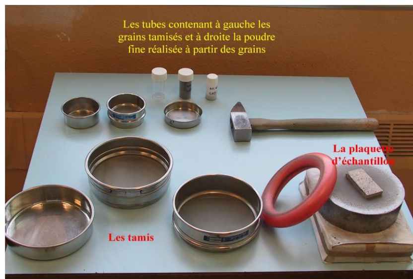
Fig. 37 : Préparation des grains et de la poudre fine à partir de l'échantillon de roche (photo H. Bellon).
