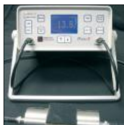
Figure 2-8 : Générateur d'impulsion Pundit 7 et deux transducteurs piézoélectriques
