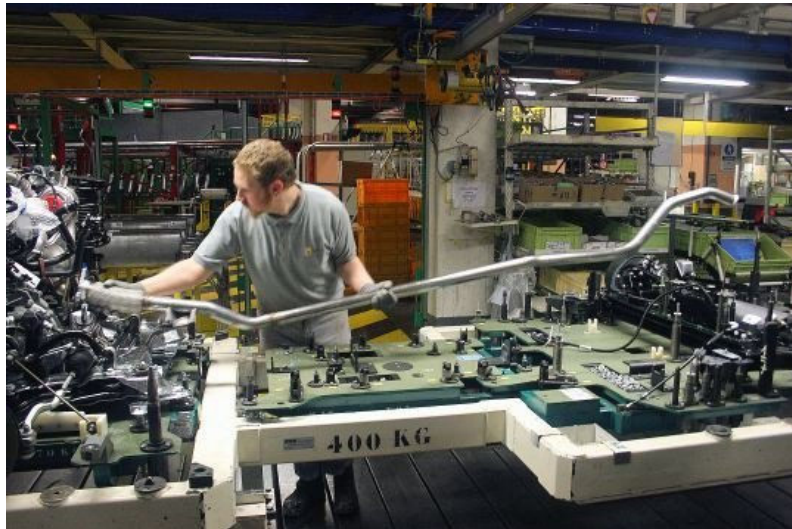
Figure 5.4 – Assemblage du sous-caisse
