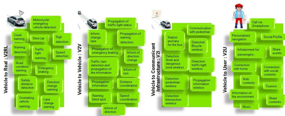
FIGURE 2.2 – Briques composants les applications véhiculaires
