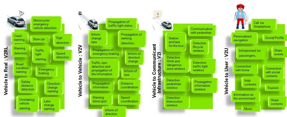
FIGURE 2.2 – Briques composants les applications véhiculaires
