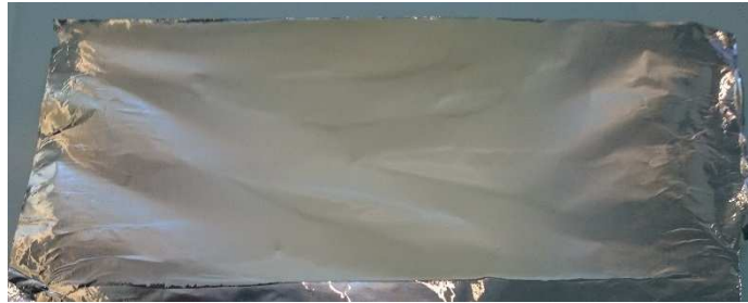
Figure III.49 : Photographie des membranes hybrides obtenues par électrospinning. Le dépôt fait 18 cm de large.
