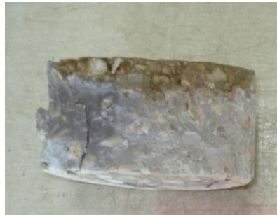
Figure 5.3 Eprouvette du BOP altérée par les ions chlore.
