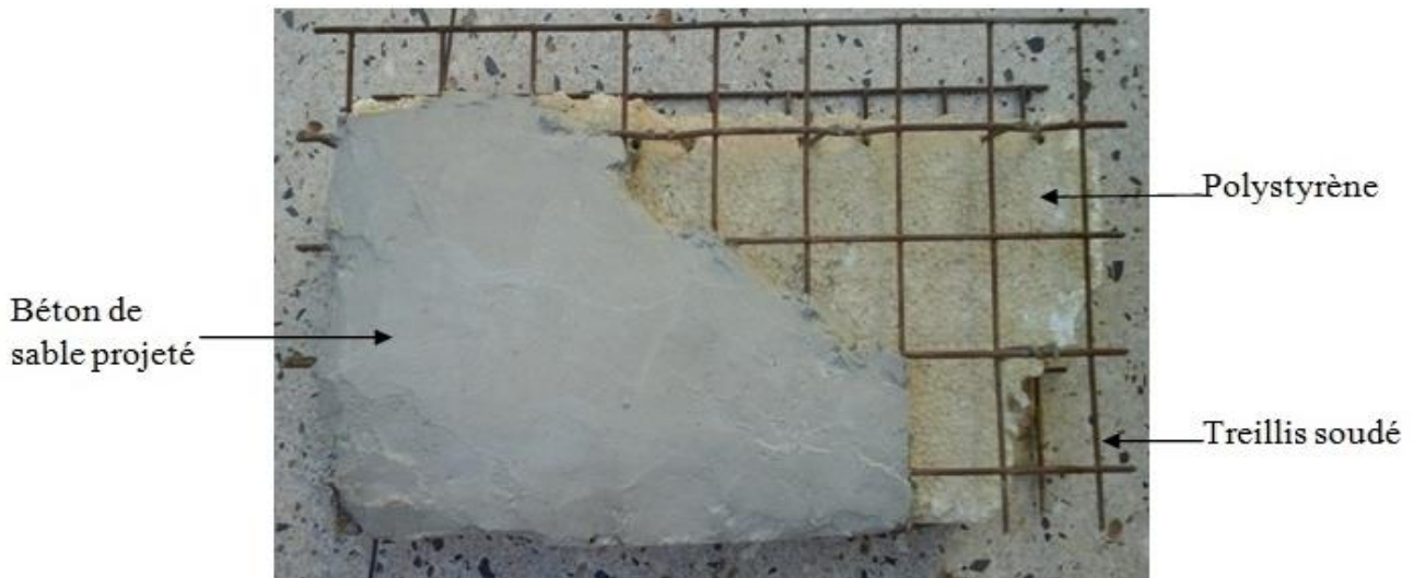
Figure 1.15a Vue en plan du panneau 3D.
