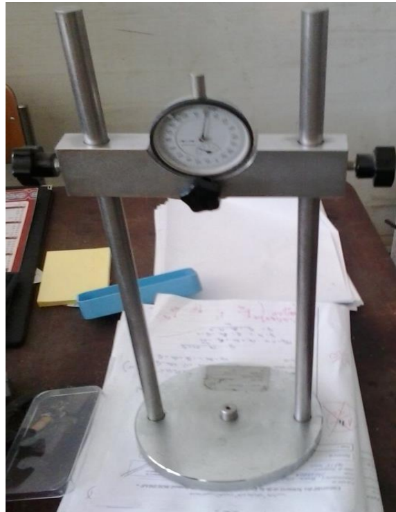
Figure 2.7 Appareil de mesure du retrait.
