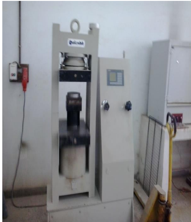
Figure 2.4 Presse de capacité 3000 KN.
