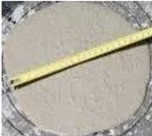
Figure 3.3 Essai d'étalement (BSP).
