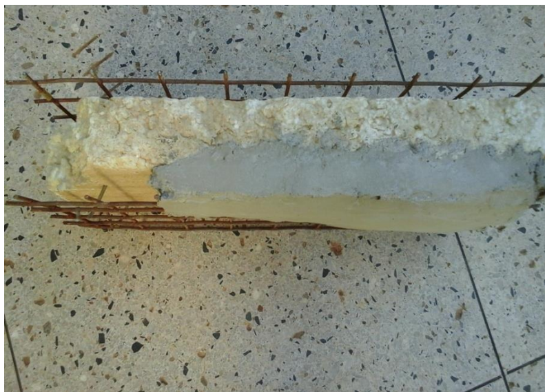
Figure 1.15b Vue transversale du panneau 3D.
