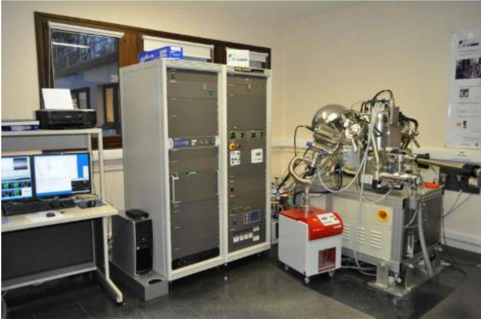
Figure II-24 Plateforme de spectroscopies électroniques XPS/Auger/UPS « Phi 5000 Versaprobe », GeePs.
