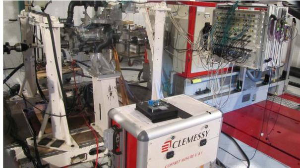
(a) Machine électrique, machine de charge, boîtier de mesure
