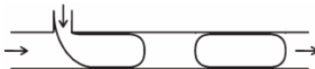
Figure I.12 : Formation d'un coude à l'interface de deux phases avant le détachement d'une gouttelette à la jonction en T dans un canal microfluidique [I-25].
