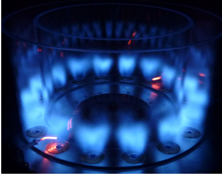
FIGURE 4 – Photographie de la chambre de combustion MICCA en cours de fonctionnement.
