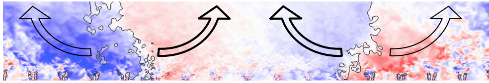
FIGURE 4.21 – Champ de vitesse azimutale lors de l'allumage à t = 30 ms (voir Fig. 4.20d). Les traits discontinus schématisent le trajet des lignes de courant côté gaz frais (traits fins) et côté gaz brûlés (traits épais).
