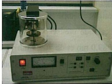
Figure II-5 : Métalliseur au carbone au LRMH
