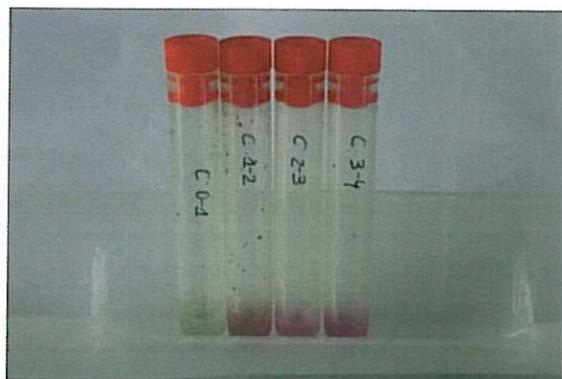
**Photo 20 :** A un pH supérieur à 9 (béton sain), la phénolphthaléine est rose vif, alors qu'elle est incolore à un pH inférieur à 9 (béton carbonaté).
