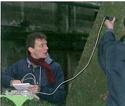
**Photo 17** : Mesures de résistivité réalisées avec un « Gecor6® ».
