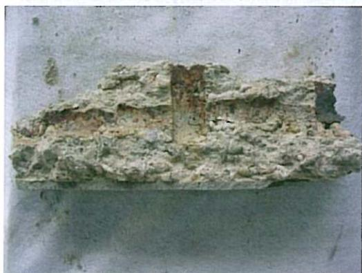
**Photo 14 :** Epaufrure au droit d'un nid de cailloux. Un enduit d'environ 1cm d'épaisseur recouvrait le béton.
