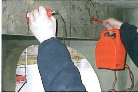
**Photo 16** : Les mesures de potentiel ont été réalisées avec un corrosimètre CANIN, équipé d'une électrode de référence au Cuivre/Sulfate de Cuivre.
