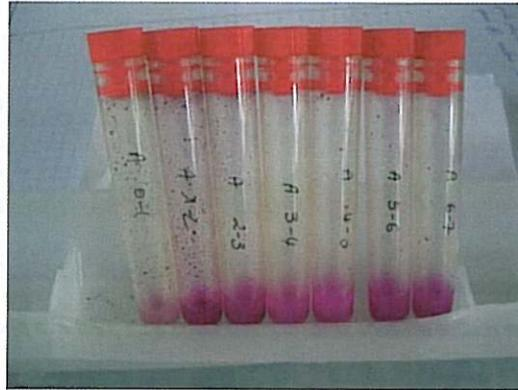
**Photo 25 :** Test à la phénolphtaléine réalisé sur prélèvements de poudre à différentes profondeurs, en zone 1.
