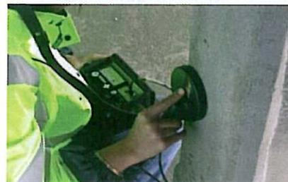
Photo 15 : Localisation des armatures avec un pachomètre « Rebar plus<sup>®</sup> ».
