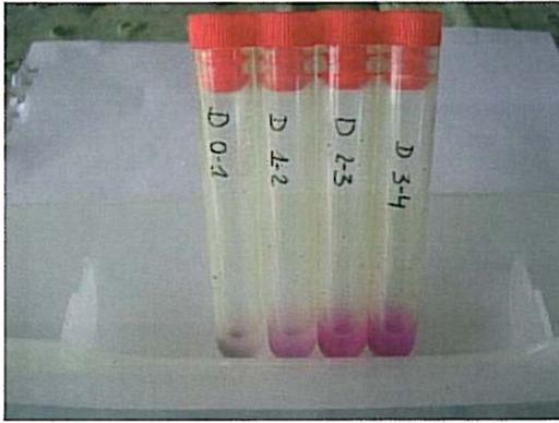
**Photo 30 :** Test à la phénolphthaléine réalisé en zone n°4.
