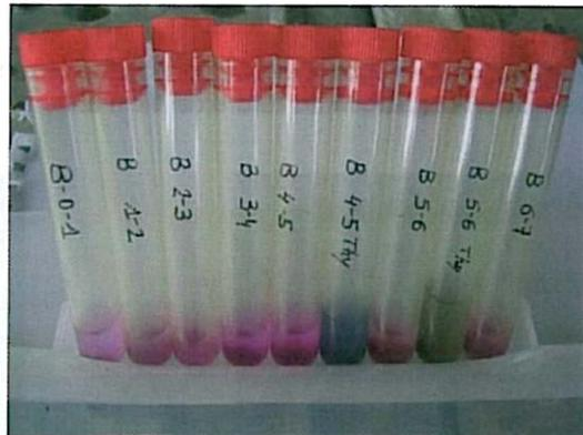
**Photo 27 :** Tests à la phénolphtaléine et à la thymolphtaléine réalisés en zone 2.
