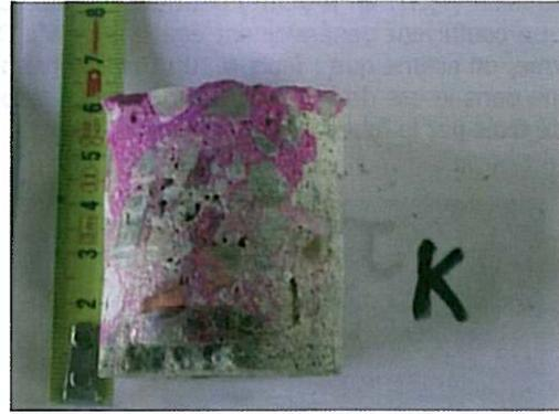
**Photo 22** : A un pH supérieur à 9 (béton sain), la phénolphthaléine est rose vif, alors qu'elle est incolore à un pH inférieur à 9 (béton carbonaté).
