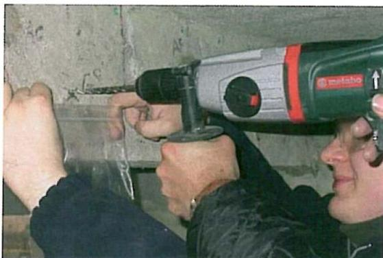
**Photo 19 :** Prélèvement de poudre à différentes profondeurs.
