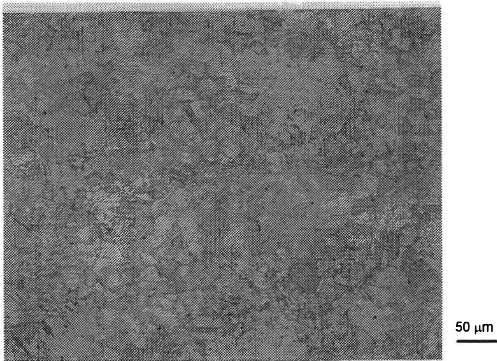
Figure 23 : Micrographie optique agrandie 200 fois d'une électrode de cuivre après une attaque au Nital permettant de révéler les joints de grain.
