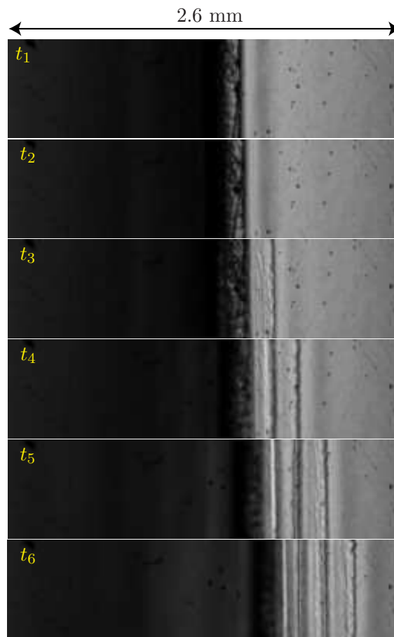
FIGURE 5.5 – Images correspondant au temps t_i (lignes verticales vertes sur la figure 5.4). En partant de la gauche on observe une zone noire, correspondant au ruban déjà pelé, puis une zone gris clair, correspondant au ruban encore collé. Les temps t_1 et t_2 sont durant la phase de stick, les temps suivants sont durant la phase de slip. Expérience réalisée avec du Scotch ® 600, avec comme substrat son propre dos nettoyé, L = 1 m, \theta = 90^\circ et V = 0.73 m s -1 .
