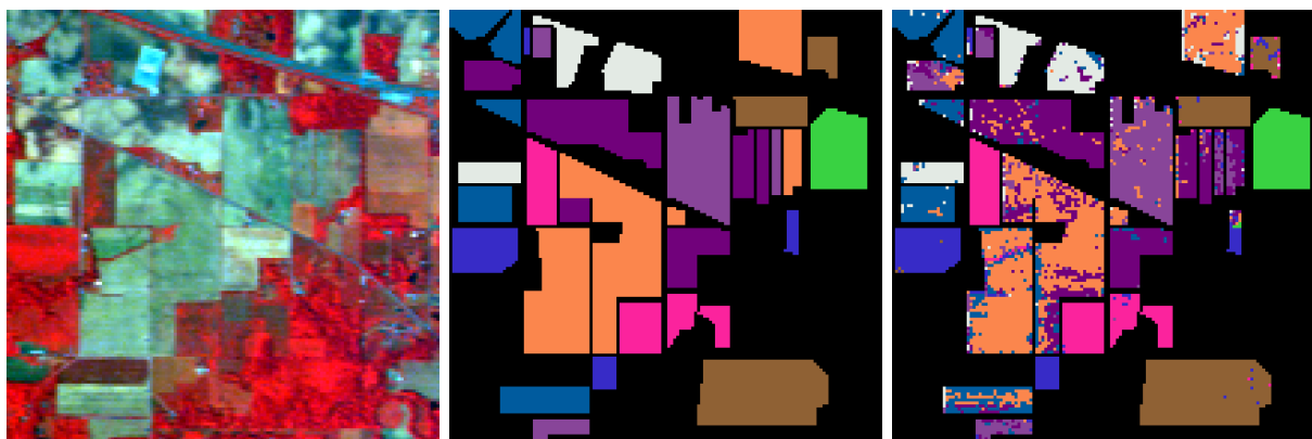
FIGURE 6.14 – De gauche à droite : image d’Indian Pines, carte de vérité terrain associée et exemple de classification obtenue par un classifieur SVM avec noyau gaussien pour un jeu de bandes optimal obtenu d’après le critère rf.appart .
